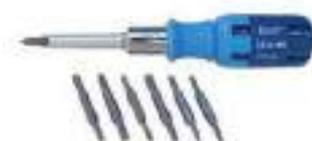
Figura 20. Herramientas con sistema carraca
