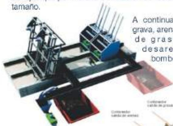
A continuación se realiza la eliminación de grava, arenas, partículas minerales, eliminación de grasas y aceites mediante los desarenadores-desengrasadores, bombeándose después a un contenedor.
