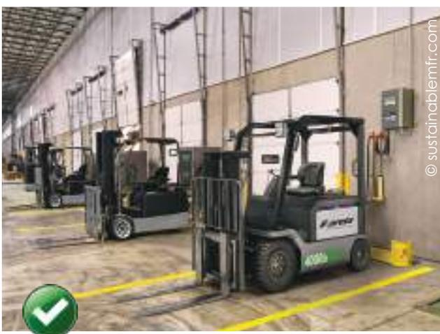
Fig. El estacionamiento de las carretillas debería llevarse a cabo en lugares designados para ello, siempre que sea posible, y aplicando una serie de pautas básicas que aseguren su total inmovilización, además de no impedir el paso ni la circulación.
