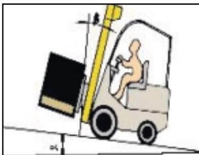
*Fig 3. Condicionantes de la circulación por rampa. Fuente: NTP 214, Carretillas elevadoras. José M.<sup>a</sup> Tamborero del Pino. INSHT.*
