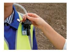
c) Se retiran los tapones del portafiltros o casete y se conecta el orificio de salida al tubo de conducción del aire con ayuda de un adaptador (En las captaciones de polvo respirable, se conecta el conjunto casete-ciclón). Antes de iniciarse el muestreo se comprueba la perfecta estanqueidad del conjunto. En los casos que se utilice ciclón, hay que asegurarse de que la alineación ciclón
