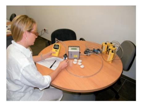
La calibración de la bomba debe realizarse con el mismo tipo de soporte o unidad de captación, con el fin de que, la pérdida de carga sea similar a la que se tendrá en el muestreo.
