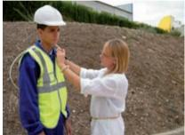
b) Se ajusta el tubo que conecta la bomba con el casete por la espalda y hombro del operario de forma que el extremo del tubo quede a la altura de la clavícula del trabajador fijándolo con una pinza a su vestimenta.
