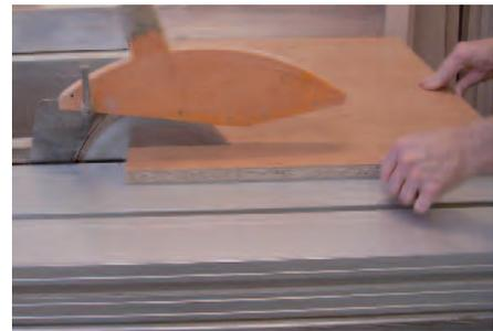
Asegurarse siempre de un **seguro guiado de la pieza**, utilizando los tope-guía correspondientes (tope-guía paralelo, regla de tope, tope-guía transversal, etc.), para cortes longitudinales y transversales.
