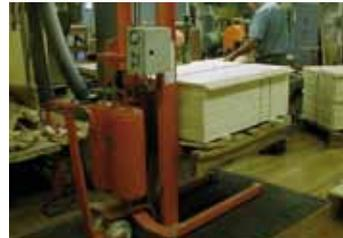
Figura 37. Ayudas para el posicionamiento de palets en altura.
