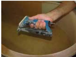
Figura 111. Herramienta con pulsador de un solo dedo.
