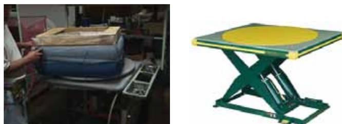
Figura 83. Mesa de trabajo con plataforma giratoria.
