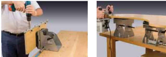
Figura 24. Sistema auxiliar de fijación por vacío.
