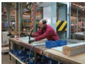
Figura 113. Sistema de sujeción contrabalanceado de la herramienta de mano.
