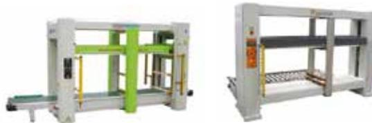
Figura 106. Prensas con carga y descarga automatizada.
