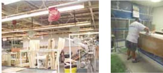
Figura 48. Sistema de enrollado superior para herramienta neumática.
