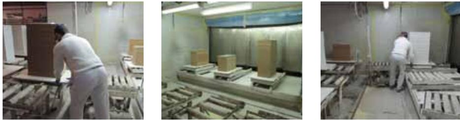
Figura 61. Sistema de transporte de piezas con rodillos.
