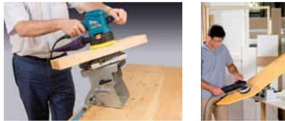
Figura 40. Sistemas de sujeción por vacío para piezas.
