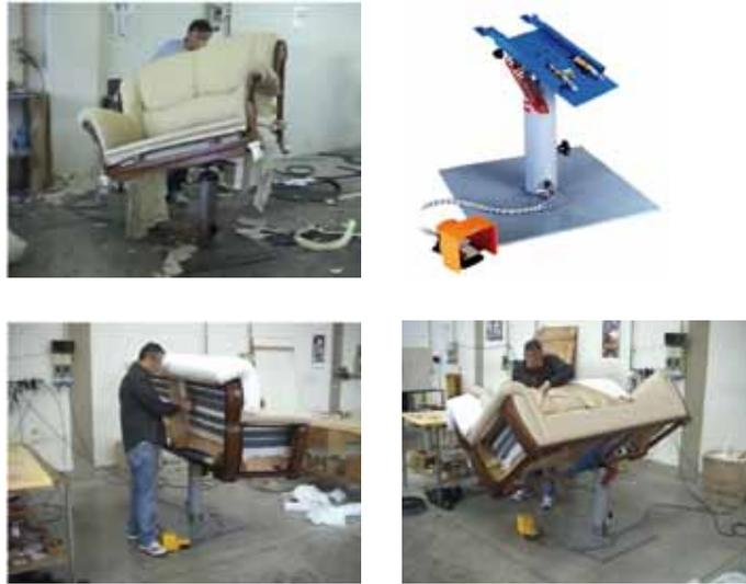
Figura 84. Columna con ajuste de ángulo de trabajo.
