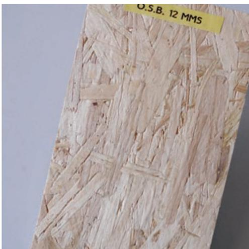
De izq. a drcha. y de arriba a abajo: Tablero de fibra de baja densidad. Tablero contrachapado o microlaminado. Más ejemplos de contrachapados. Tablero de fibras rechapado de madera natural. Tablero Aglomerado. Tablero de virutas OSB
