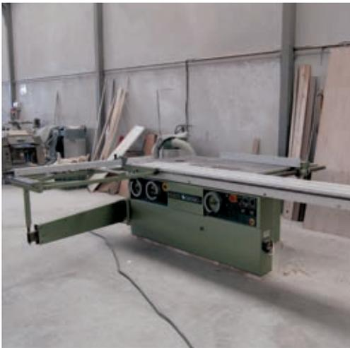
misión; retroceso de la pieza a cortar; proyección del disco o parte de él; ruido; inhalación de polvo de madera; posturas forzadas y sobreesfuerzos.
