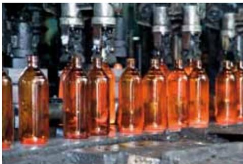
El vidrio, ya tratado y en frío, es sometido a **controles de calidad**, mediante máquinas automáticas de control y por procedimientos manuales de inspección. Los envases que no superan dichos controles son desechados y reincorporados al proceso de fusión.
